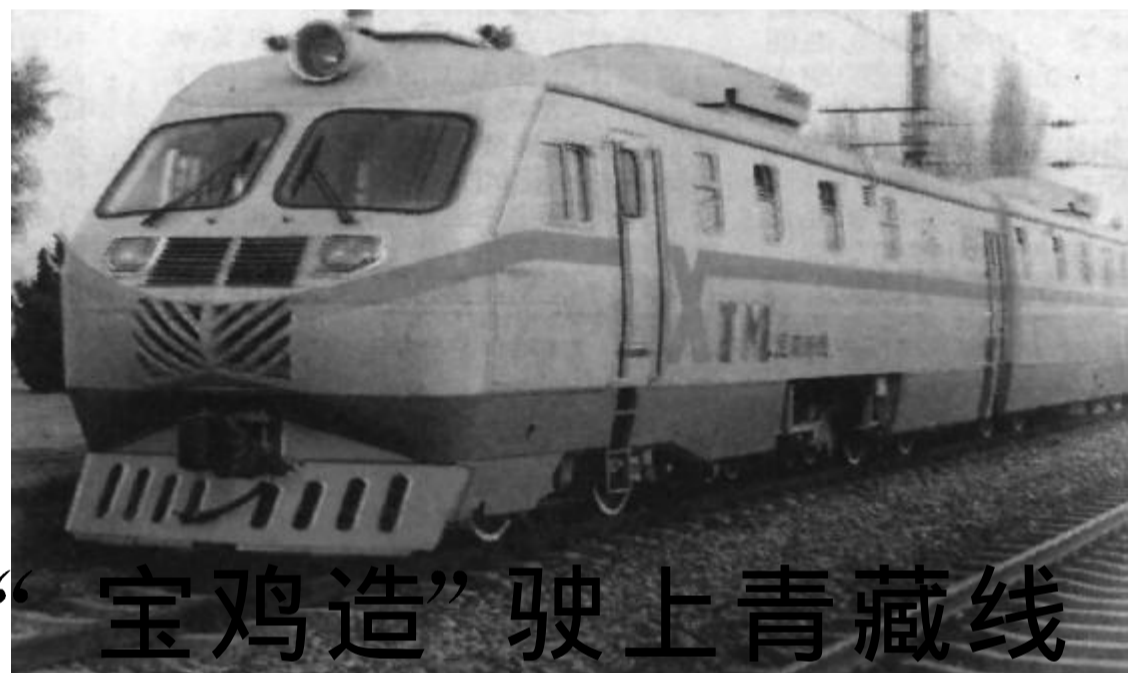
由中铁宝工有限责任公司与国外合作开发生产的我国第一台高原钢轨探伤车,日前已发往青藏线。探伤车由于能够适应高原气候环境,自动化、机械化程度高,运行中可对钢轨的危险部位自动涂漆并报警,因而将承担起高原铁路的探伤、巡检任务。(黑枫 高正刚 摄影)
